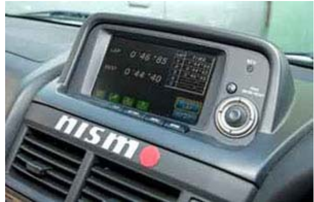
Banyak fungsi yang terpantau dari layer ini, mulai dari waktu perpindahan gigi transmisi (shift light), boost turbo, kinerja injector, temperature oli dan air, G force meter, hingga lap time. Khusus buat lap time, dibuatkan tombol tambahan di samping tuas persneling.
