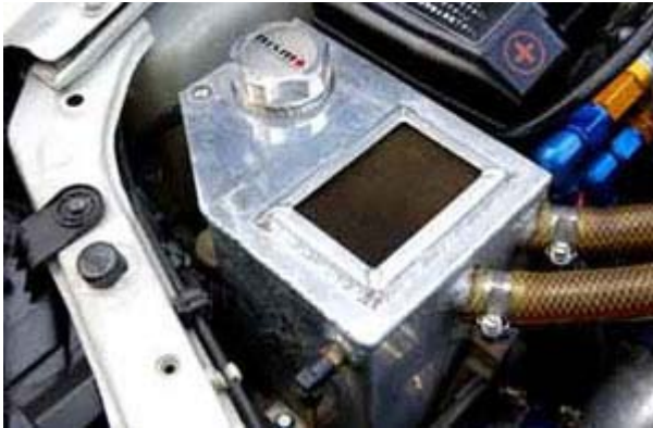
Oil catch tank dengan dual input berguna menampung oli hasil penguapan mesin
