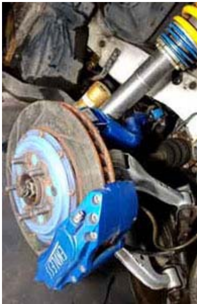
Tak hanya sok breker dan rem belakang yang diganti, stabilizer, bushing dan arm ikut dimaksimalkan dengan produk Cusco
